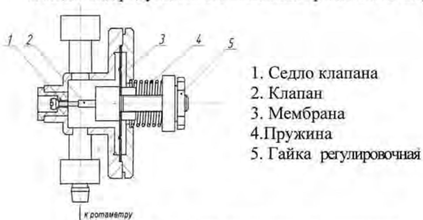
Рис.3 Общий вид редукционного клапана.
